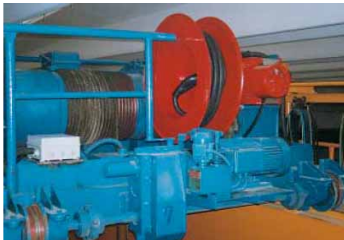
Барабан для вертикальной намотки для работы в сталелитейном производстве.
