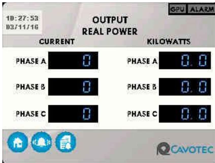
Рисунок 3-36. Экран «Output Real Power»
