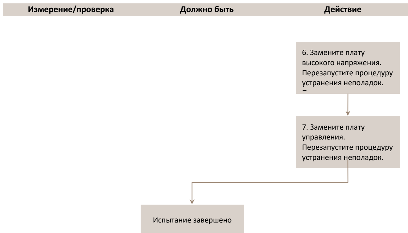
Рисунок 2-3 (Продолжение). Блок-схема устранения неисправностей, аварийный сигнал входного напряжения.
